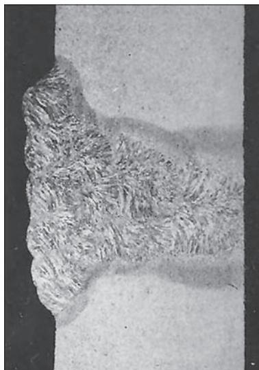
Рис. 2. Макрошлиф сварного соединения трубы, выполненного автоматической сваркой в среде углекислого газа
