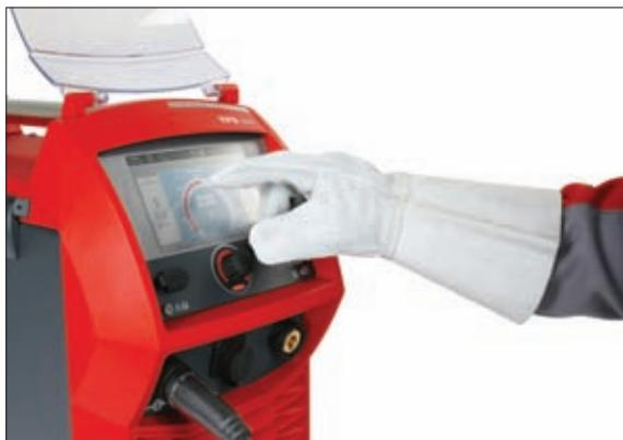
Сенсорный 7-дюймовый графический дисплей, на котором отображаются интуитивно понятные графические и текстовые сообщения, гарантирует полный контроль при выполнении сварочных работ
