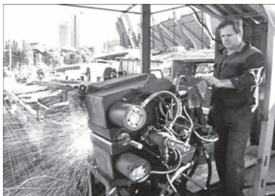
Рис. 6. Подвесная контактная стыковочная машина K813, адаптированная для сварки арматуры в условиях строительной площадки
