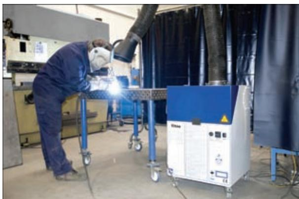
Из класса центральных систем следует обратить внимание на систему **AIRTECH**, предназначенную для очистки воздуха на промышленных предприятиях с высокой концентрацией дыма.
