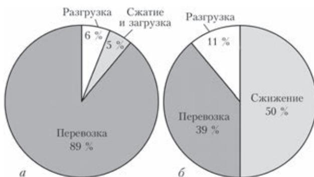
Рис. 1. Ценовая составляющая для проектов КПП (а) и СПГ (б)ческие характеристики 20- и 40-футовых морских контейнеров и массогабаритные показатели комплектующих баллонов представлены в табл. 2.
