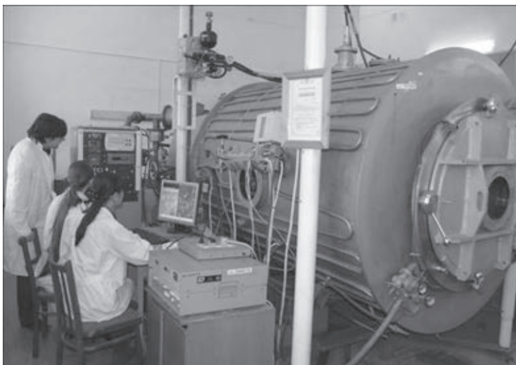
Сверхвысоковакуумная установка ВВУ-1Д. Молодые ученые за исследованиями (2012)
