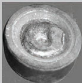
Штамп для объемной штамповки колец, наплавленный порошковой проволокой ПП-АН130
