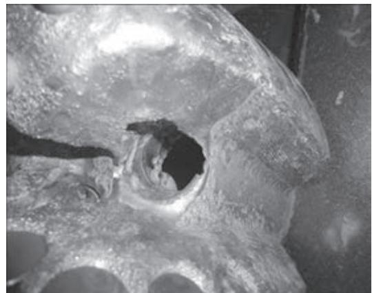
Рис. 1. Внешний вид износа рабочего органа промывочного канала стального корпуса с упрочняющим защитным покрытием
