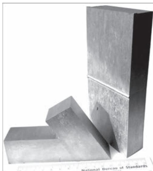
Рис. 1. Макрошлифы углового и стыкового соединений листового технического титана, выполненных ЭЛС
