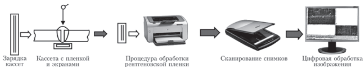
Рис. 1. Традиционная схема радиографического контроля с использованием пленки и оцифровки рентгенограмм
