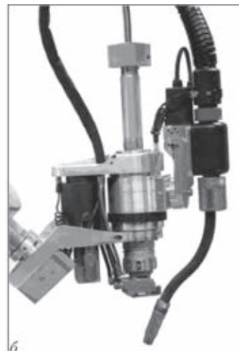
Рис. 3. Головки для гибридной лазерно-дуговой роботизированной сварки фирм «Fronius» (а) и «Cloos» (б) [4]: 1 — устройство подачи проволоки; 2 — забор воздуха; 3 — фиксация на руке робота; 4 — защитное стекло; 5 — кросс-джет; 6 — водоохлаждаемый мундштук
