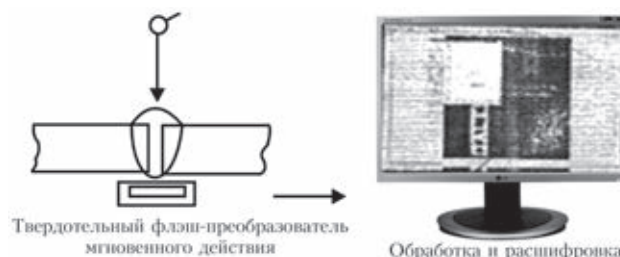
Рис. 3. Схема просвечивания без промежуточных носителей информации
