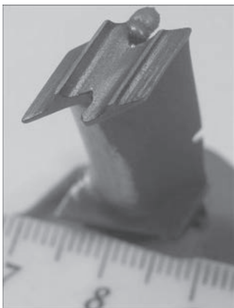
Рис. 4. Лопатка после восстановления Z-образного профиля (основной и наплавленный металл — сплав ЖС6К)
