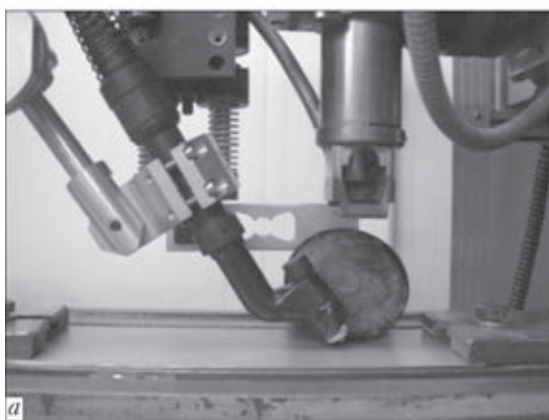
Рис. 4. Процесс гибридной лазерно-плазменной сварки с наклонным расположением плазменной горелки, позволяющей изменять расстояние между плазмой и лазерным пучком [14]: а — внешний вид гибридной лазерно-плазменной сварочной головки; б — технологическая схема процесса
