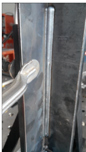
Вертикальный шов, сварка снизу-вверх (PF), сварочный процесс LSC Universal. Преимущества: стабилизация длины дуги и проплавления, отсутствие брызг, высокая стабильность процесса
