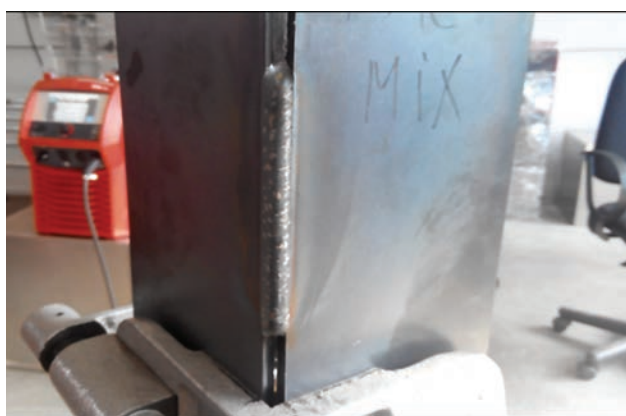
Сварка по зазору, корневой проход сварочный процесс LSC Root (положение PG), заполняющий — PMC-MIX (без колебаний, положение PF). Преимущества: стабилизация длины дуги, отсутствие брызг, высокая стабильность сварочной дуги
