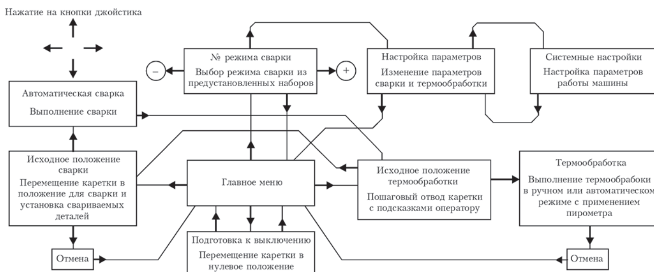
Рис. 3. Блок-схема машины с микроконтроллерной системой управления
