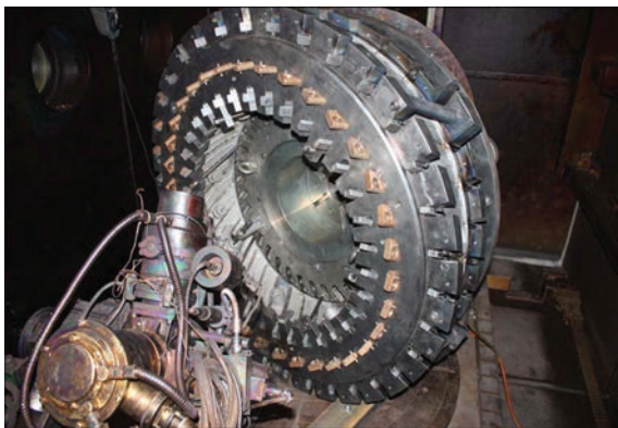
Рис. 7. Внешний вид наружной части переднего корпуса КСД, установленного на вращателе с горизонтальной осью вращения для ЭЛС внутренних стыков стоек. Электронно-лучевая пушка установлена под углом \angle G = 35^\circ
