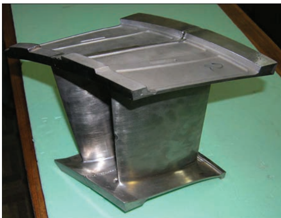
Рис. 3. Внешний вид лицевого и корневого валиков шва на стойках-образцах при ЭЛС наружных и внутренних стыков: U_{\text{вск}} = 60 \text{ кВ} , v_{\text{св}} = 12 \text{ мм/с} , l_{\text{раб}} = 250 \text{ мм}
