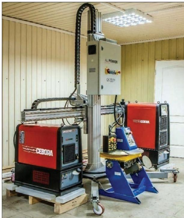
Инновационное универсальное оборудование для плазменной, гибридной и комбинированной («Плазма-МИГ») сварки, разработанное в ИЭС им. Е. О. Патона и поставленное на лабораторно-технологическую базу КУИС в г. Гуанчжоу, КНР
