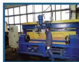
Установка для наплавки тел вращения
