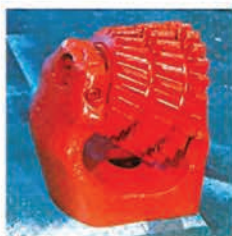
Наплавка вооружения и лап буровых долот
