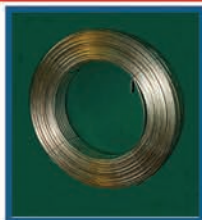
Порошковые ленты для износостойкой наплавки
