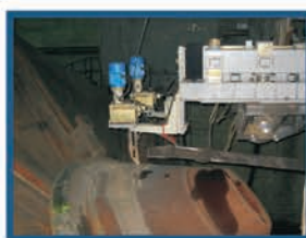
Аппарат для наплавки конусов и чаш доменных печей
