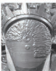
Наплавка вооружения и лап буровых долот
