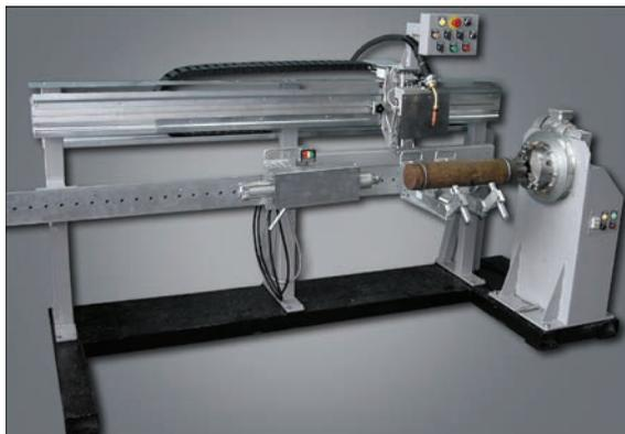
Рис. 2. Установка **AC305-1M** для автоматической дуговой МИГ-сварки гидроцилиндров
