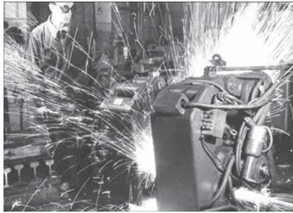
Испытания аппарата контактной стыковой сварки рельсов, 1960 г.
