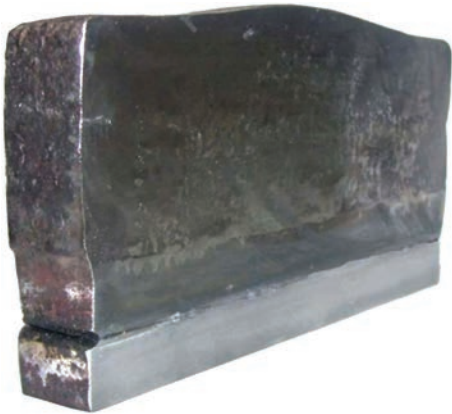
Рис. 4. Внешний вид боковой поверхности наплавленного слоя с использованием флюса АН-26 при первоначальном значении L 0 , равном 70 мм (продольный шлиф наплавленной заготовки)
