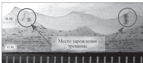
Рис. 8. Внешний вид боковой поверхности образца с участками, где зародились усталостные трещины: о.м. — основной металл; н.м. — наплавленный металл
