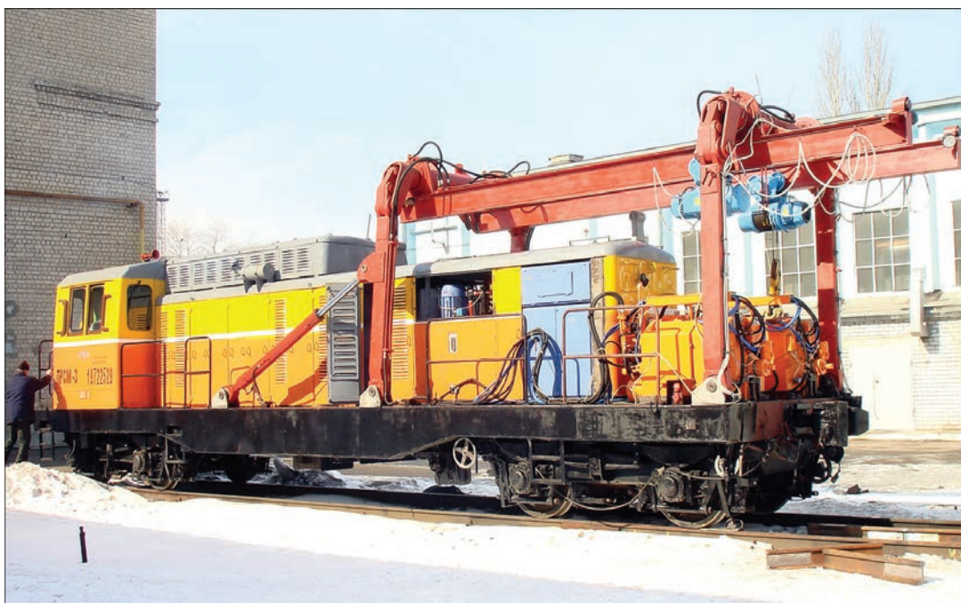
Передвижной рельсосварочный комплекс на железнодорожной платформе
