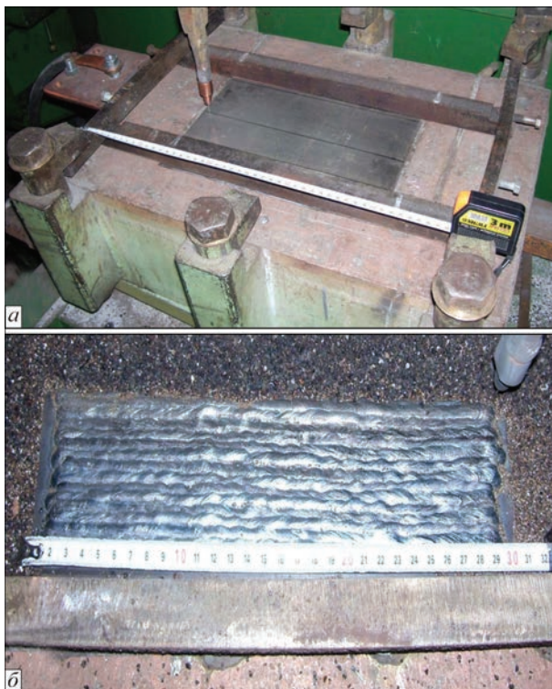
Рис. 5. Внешний вид стального листа толщиной 3 мм, подготовленного под наплавку (а), и фрагмент наплавленного листа (б)
