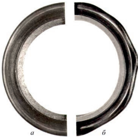
Рис. 6. Внешний вид наплавленных валиков при длине ванны меньше критической (а) и большей (б); D = 90 мм; b = 7 мм
