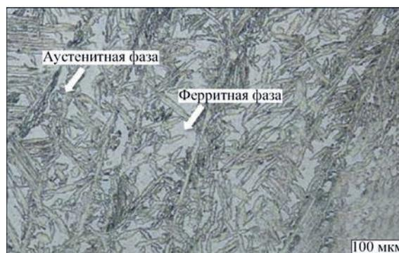
Рис. 3. Микроструктура металла шва дуплексной нержавеющей стали
