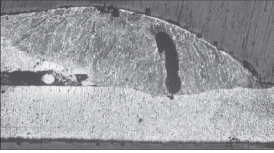
Рис. 1. Макроструктура напускного з'єднання оцинкованої сталі, отриманого шляхом MAG зварювання
