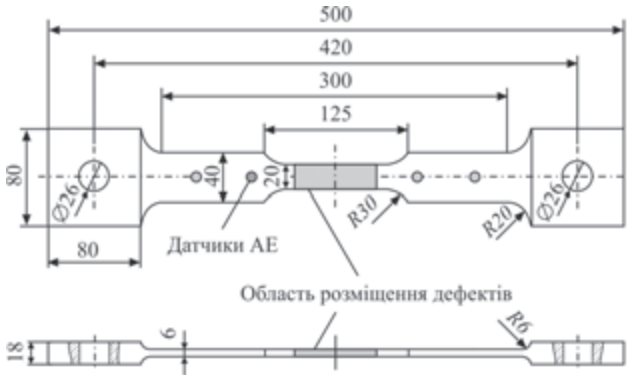
Рис. 3. Зразок для проведення випробувань з застосуванням АЕ технології
