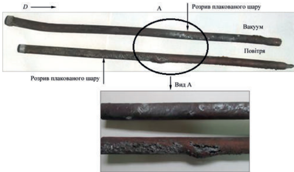
Рис. 8. Коаксіальна заготовка після зварювання вибухом. Загальний вигляд, зверху – з вакуумом, знизу – без вакууму, напрямки детонації зліва направо. Вигляд А – розрив плакованого шару, зверху – з вакуумом, знизу – без вакууму
