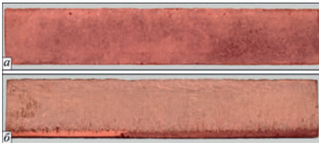
Рис. 5. Формування металу шва в продольному перетині по вісі з міді марки М1 довжиною 100 мм при ЕПЗ у нижньому положенні по стику ( \times 1,5 ): а – без проставки; б – з проставкою з ВТ1-00 товщиною \delta = 0,05 мм. Режим ЕПЗ: U_{\text{приск.}} = 60 кВ; I_{\text{п}} = 197 мА; v_{\text{зв}} = 7,5 мм/с; +\Delta I_{\text{ф}} = 5 мА; I_{\text{роб}} = 200 мм; D = 1,5 мм
