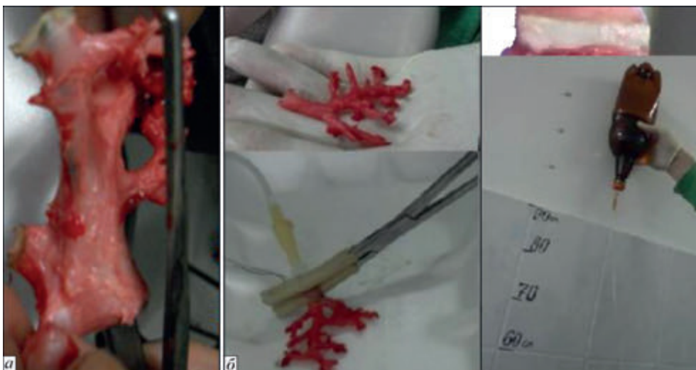
Рис. 6. Випробування зварних швів бронхів, отриманих в умовах застосування спеціальних алгоритмів зварювання: а – перевірка на прохідність; б – гідрравлічні випробування
