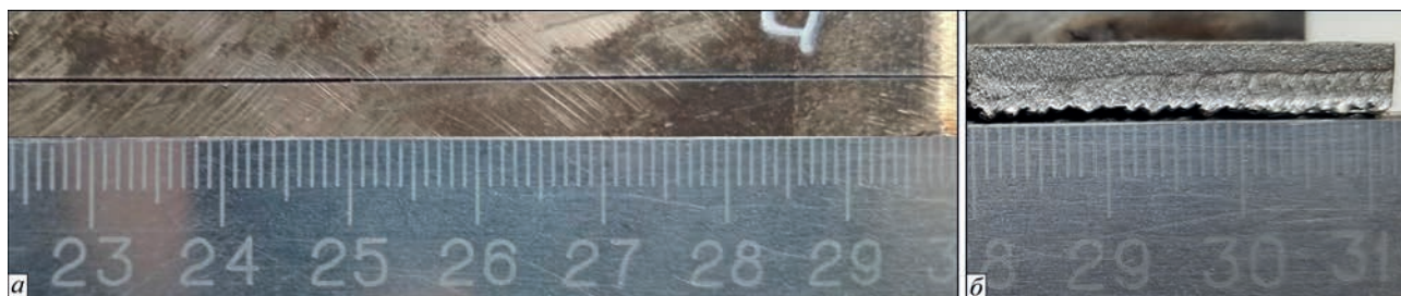
Рис. 3. Ширина (а) і крайка (б) лазерного різку профільної труби зі сталі типу Q235 (товщина стінки 5 мм)
