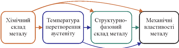
Рис. 3. Взаємний вплив хімічного складу, температури перетворення аустеніту, структурно-фазового складу на механічні властивості металу зварного шва
