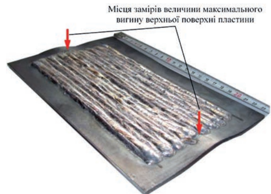
Рис. 7. Схема замірів величини деформації листа після наплавлення
