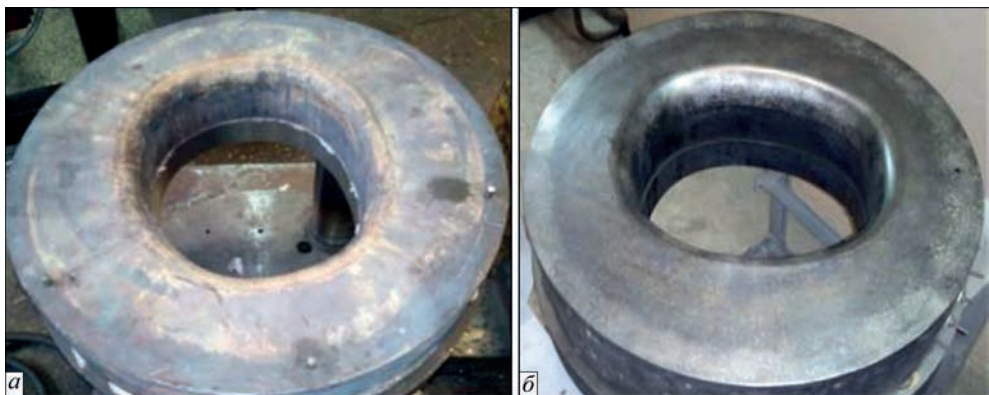
Рис. 6. Поверхня штампа для глибокої витяжки виробів з листа титану ВТ-6: а – немодифікована; б – модифікована імпульсною плазмою з комплексним легуванням вуглецем, вольфрамом і киснем
