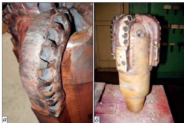
Рис. 6. Нанесення покриття на робочі органи долота: а – лопать; б – долото після паяння алмазно-твердосплавних різців і вставок
