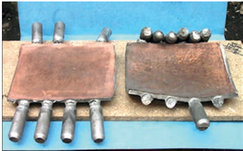
Рис. 7. Відрив трубних елементів під час зварювання вибухом
