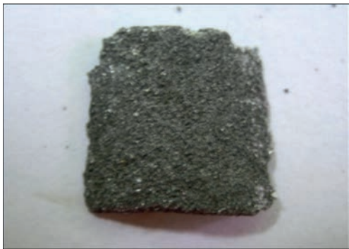
Рис. 11. Відшарований шар після випробування на сплющування
