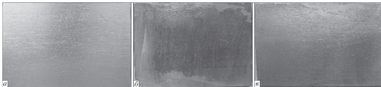
Рис. 1. Зовнішній вигляд поверхні основного металу алюмінієвого сплаву 2219, термообробленої до стану Т81, до (а) та після випробувань в амалі (б) та парах амалу (в)
