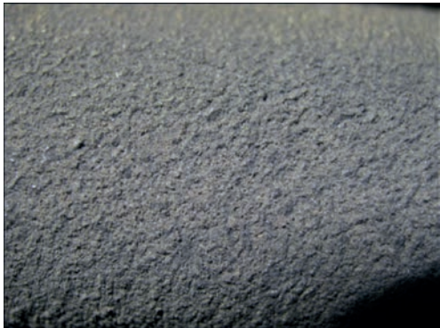
Рис. 12. Макроструктура напилених труб після шести років експлуатації
