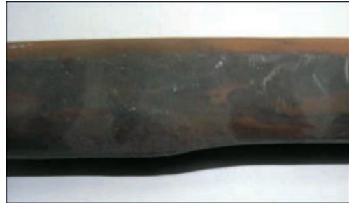
Рис. 4. Характер пошкодження труби діаметром 32×6 мм ВЕ в результаті дії золотого зносу
