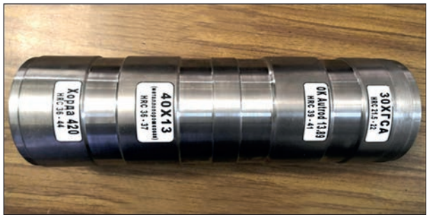
Рис. 9. Зразок-імітатор вісі колісної пари
