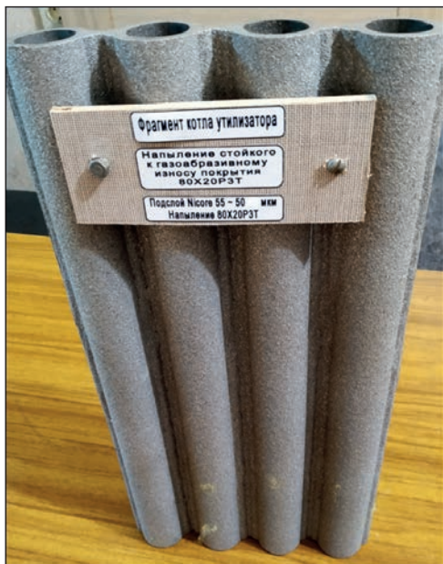
Рис. 5. Фрагмент поверхні охолодження котла-утилізатора
