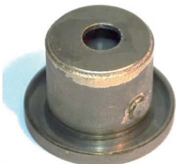
Вузол фотоприймача Ti – Kovar
