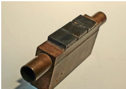
Модель дивертора Cu – W
