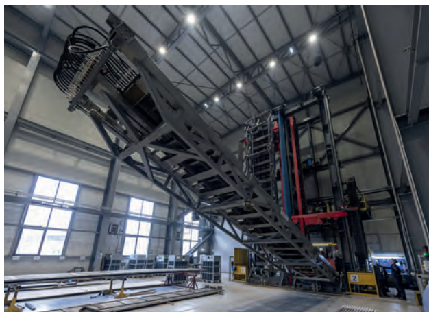
Механізована колона для плакування з використанням методу СМТ: ребристі стінки зафіксовано, вигляд із платформи
