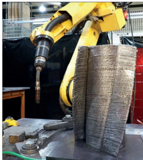
Рис. 7. Наплавлення багатошарової деталі за допомогою технології WAAM [23]
