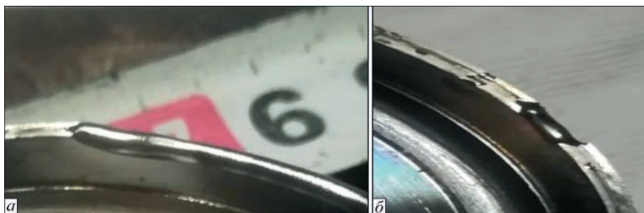
Рис. 2. Початковий фрагмент шва (а) та прихватка (б)
