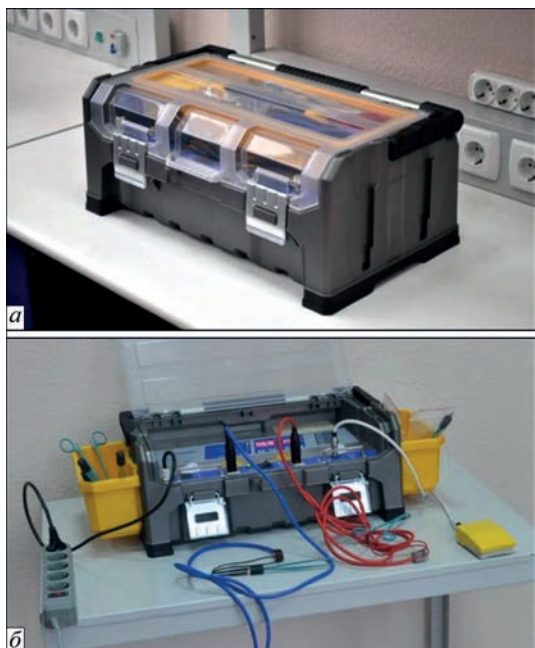
Рис. 14. Зовнішній вигляд мобільної версії апарату ЕКВ3-300 в транспортному (а) та робочому (б) положенні
