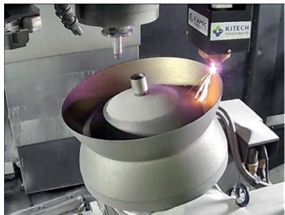
Рис. 5. Процес наплавлення паливного бака ракети-носія [21]
