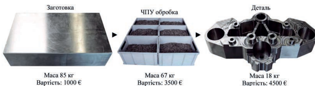
Рис. 1. Процес виготовлення металевої деталі способом механічної обробки [9]
