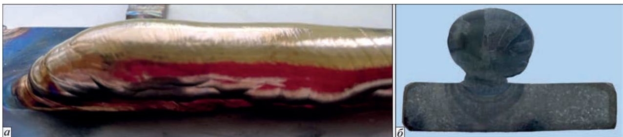
Рис. 2. Загальний вигляд наплавленого з'єднання (а) та його макрошліф (б)
