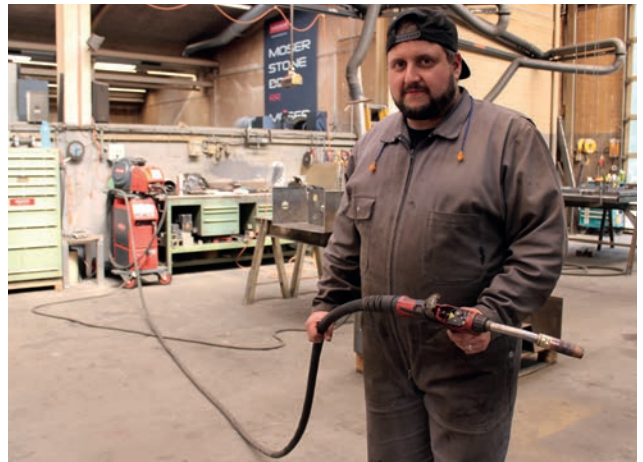
Зварювальний пальник підключено до зварювальної системи за допомогою 10-метрового шлангового пакета
