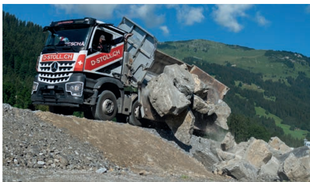
Вантажівка з кузовом типу «Rockbox» від компанії Moser розвантажує кам'яні брили у швейцарських горах. Кузов «Rockbox» має сучасну зварну композитну конструкцію, яка відповідає високим вимогам щодо легкості та міцності
