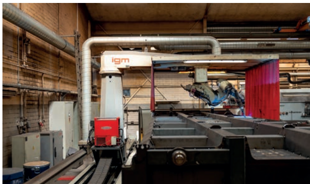
Зварювальний робот виконує зварювання основи самоскида стандартного типу за допомогою Fronius TPS 5000
