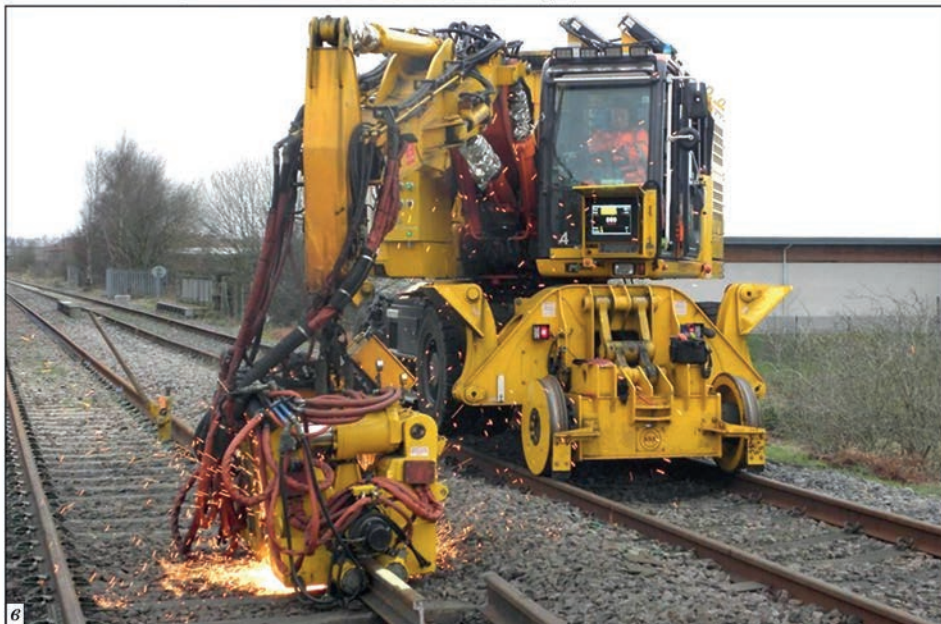
Рис. 12. Мобільні машини K960 (а), K945 (б), рейкозварювальний комплекс з машиною K945 (в) для КСЗ рейок з «натягом»
