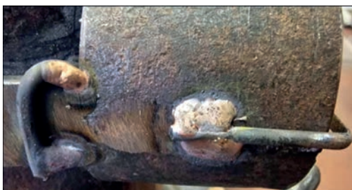
Рис. 4. Зовнішній вигляд з'єднання деталі із дроту діаметром 3 мм та труби діаметром 60 мм із товщиною стінки 3 мм
