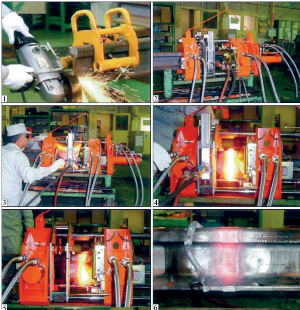
Рис. 5. Послідовність технологічних операцій при ГПЗ [19]: 1 – зачистка кінців рейок; 2 – налаштування апарату для ГПЗ; 3 – у процесі ГПЗ (процес нагрівання); 4 – закінчення процесу ГПЗ (осадка); 5 – зрізання грату; 6 – зварна деталь відразу після ГПЗ
