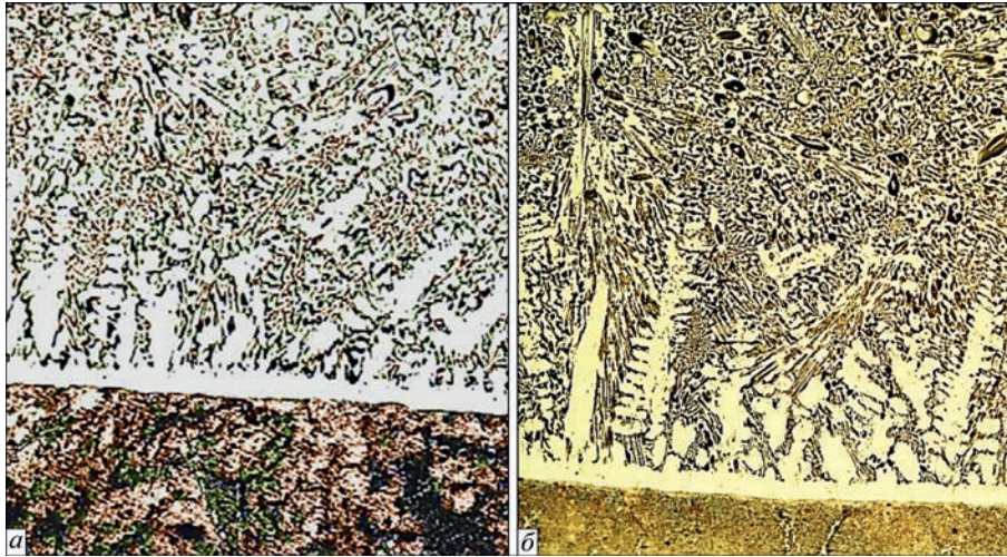
Рис. 1. Мікроструктура ( \times 200 , зменш. 2/3) наплавленого зразка сталь 3+Сормайт-1: a – після наплавлення; б – після старіння
