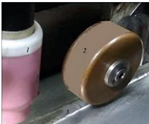
Рис. 1. Процес 3D друку із пластичним деформуванням наплавленого шару електродинамічною обробкою: 1 – пальник для 3D друку; 2 – циліндричний електрод-індентор із контактною поверхнею у формі прямої лінії; 3 – надрукований шар металу
