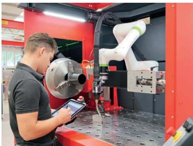
Оператор комірки Fronius CWC-S налаштовує зварювальне завдання компонента
