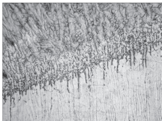
Рис. 8. Мікроструктура ( \times 500 ) металу вихідного початкового шва і ЗТВ ребра таврового зварного з'єднання після ремонтного зварювання
