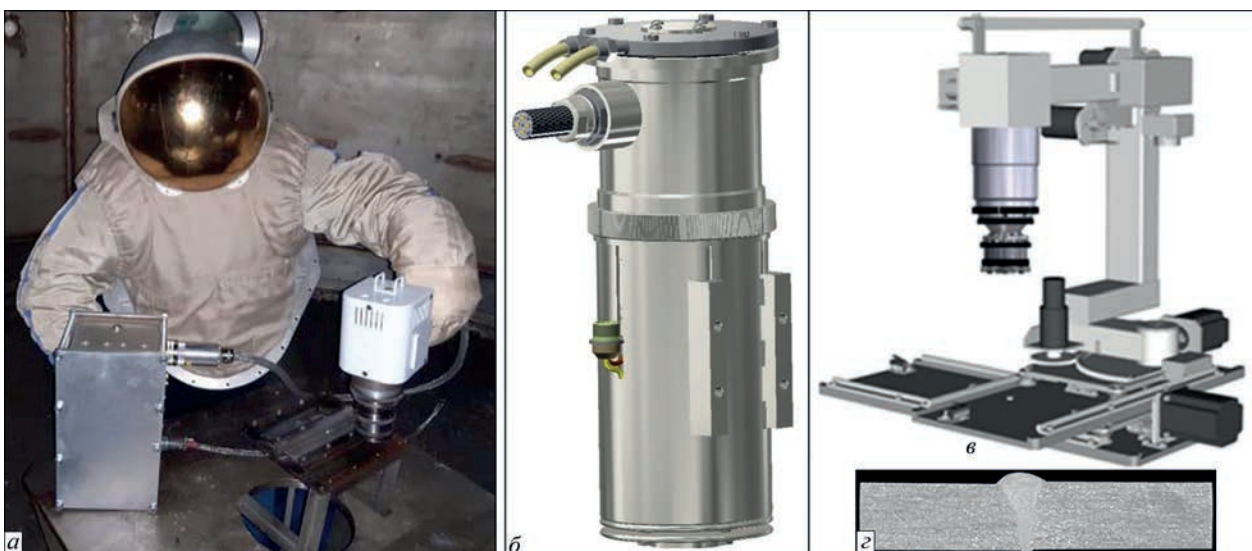
Рис. 8. Ручний електронно-променевиий інструмент нового покоління та гармата для зварювання і 3D-принтіngu для довготривалої роботи: а – прототип комплексу ручного інструменту, випробуваний при виконанні технологічних експериментів; б – загальний вигляд електронно-променевої гармати для зварювання в космосі в складі маніпулятора або робота; в – спеціальний маніпулятор з 5-ма ступенями свободи, створений для виконання процесу автоматичного зварювання; г – макроструктура алюмінієвого сплаву АМг6 завтовшки 8 мм
