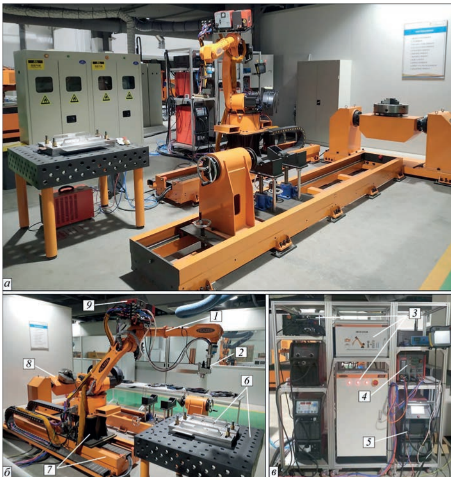
Рис. 1. Загальний вигляд роботизованого комплексу обладнання PLAZER PAW-R для плазмово-дугового зварювання довгомірних зварних з'єднань на різнополярному асиметричному струмі із вильотом руки робота до 2000 мм і системою переміщення робота до 3000 мм (а, б) і стійки із джерелами живлення робота, плазмотрона, шафою адаптації команд для робота і інтелектуальною автоматичною системою моніторингу зварювального обладнання (в): 1 – антропоморфний зварювальний робот; 2 – зварювальний плазмотрон; 3 – інтелектуальна система керування процесом роботизованого зварювання; 4 – плазмовий модуль; 5 – джерело живлення плазмового зварювання; 6 – зварювальний стіл зі складально-зварювальним пристроєм; 7 – система лінійного переміщення робота по рейках; 8 – двохосовий обертач-маніпулятор; 9 – механізм подавання присадного дроту
