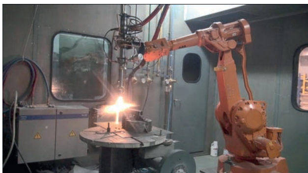
Рис. 3. Пристрій для нанесення покриттів з використанням БКДП
