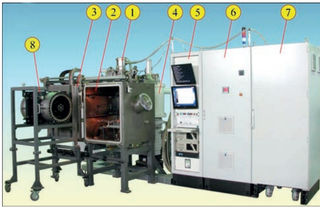
Рис. 4. Установка для ЕПО твердосплавних заготовок: 1 – електронно-променева гармата; 2 – вакуумна камера; 3 – зсувні двері; 4 – вакуумна система; 5 – шафа керування; 6 – силова шафа; 7 – шафа зварювального високовольтного джерела живлення; 8 – завантажувальний пристрій для двох барабаних магазинів деталей
