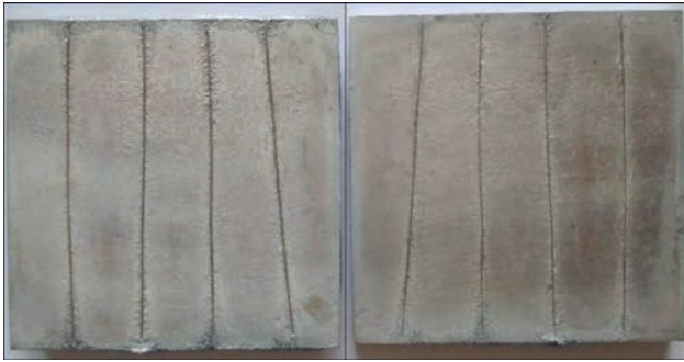
Рис. 5. Поверхні пластини сплаву АМг6 після термічного циклу нагрівання в умовах їх стискання із зусиллям 100 кПа
