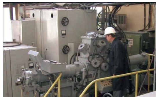
Рис. 3. Установка для вирощування монокристалів тугоплавких металів у вигляді пластин
