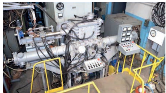
Рис. 5. Новітня установка з комп'ютерним керуванням для вирощування монокристалів тугоплавких металів у вигляді тіл обертання
