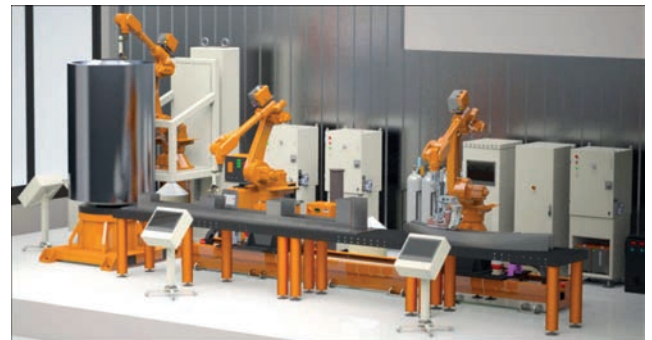
Рис. 22. Загальний вигляд дільниці з трьох роботизованих комплексів для 3D друку великогабаритних і циліндричних оболонок і довгомірних складнопрофільних конструкцій із алюмінієвих і титанових сплавів із використанням адитивних плазмово-дугових технологій
