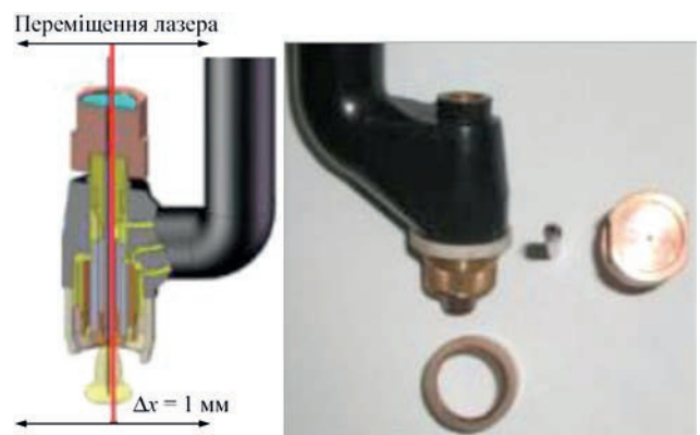
Рис. 5. Головка для лазерно-плазмового мікрозварювання та різання металів малих товщин (потужність випромінювання 100 Вт, зварювальний струм 40 А) [24]
