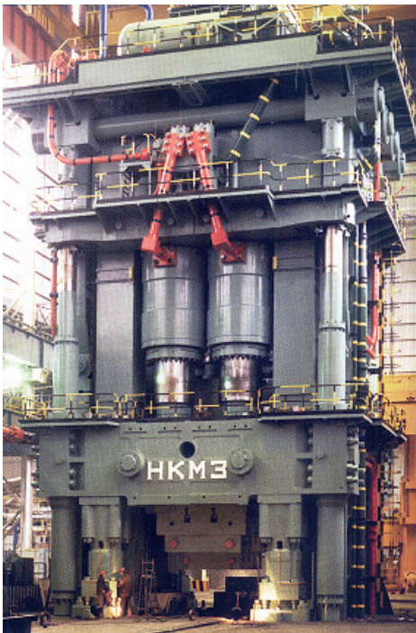
Разом з Новокраматорським машинобудівним заводом розроблено технологію електрошлакового зварювання металу завтовшки до 2000 мм (прес зусиллям 650 МН, виготовлений на НКМЗ для Франції із застосуванням ЕШЗ, 1957 р.)
