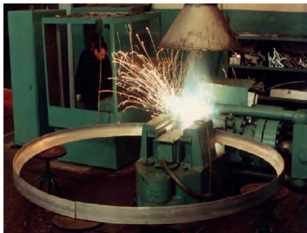
Зварювання шпангоута на «Південному машинобудівному заводі»
