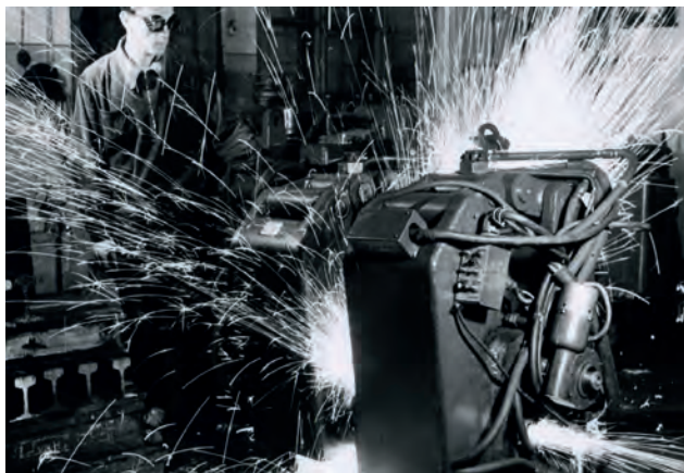
Випробування апарата для зварювання залізничних рейок в ІЕЗ
