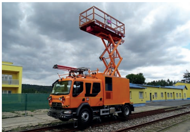
Дводорожня машина R DUOTRAM H застосовується на автомобільних дорогах, залізничних і трамвайних коліях переважно для обслуговування контактних ліній
