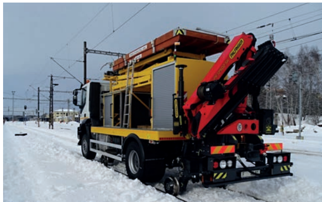
Дводорожня машина IT DUOLINER оснащена робочою платформою з ножицями для виконання робіт із технічного обслуговування залізниць, гідравлічним краном та вимірювальним пантографом
