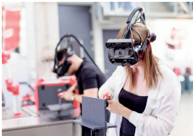
Приголомлива реалістичність: використання технології доповненої реальності, оригінальних зварювальних пальників і корпусу справжньої зварювальної системи допомагає максимально правдоподібно відтворити умови зварювання
