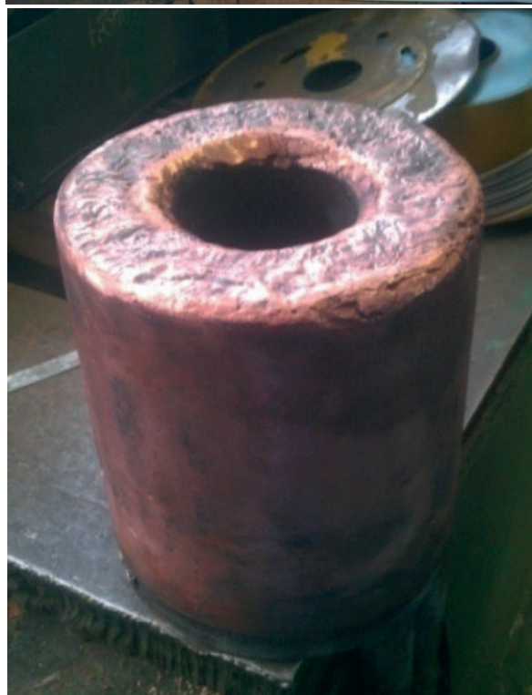
Застосування порошкового дроту ПД-АНМ1 при зварюванні струмопідводів і відновленні фурми, виготовлених із міді
