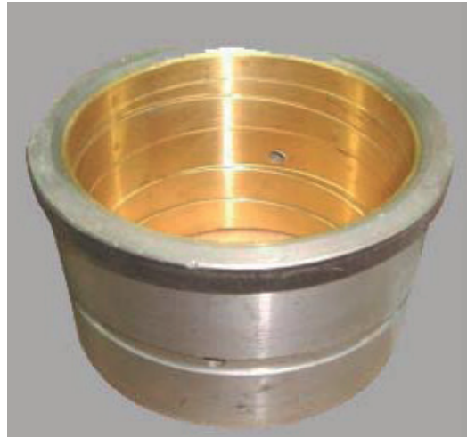
Біметалева втулка сталь+складнолегована алюмінієва бронза після наплавлення та механічної обробки
