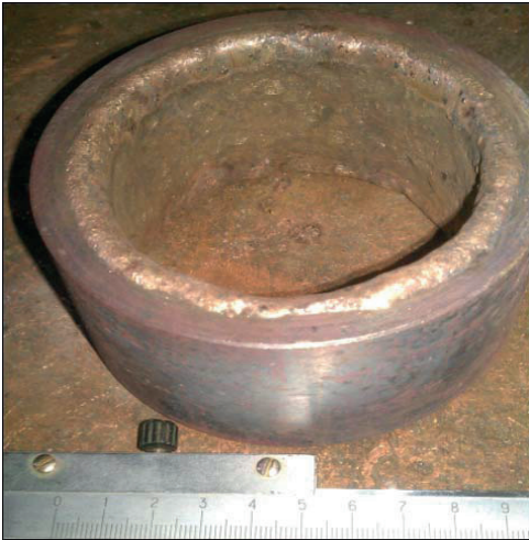
Біметалева втулка сталь+складнолегована алюмінієва бронза після наплавлення та механічної обробки
