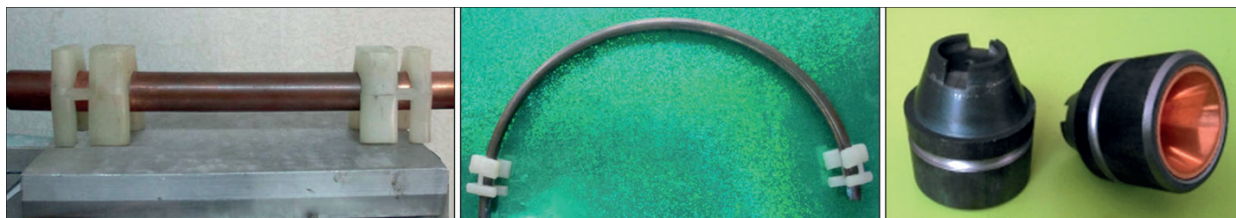
Стандартні кумулятивні заряди (лінійний та кільцевий) та перфоратор для нафтогазової промисловості
