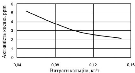
Рисунок 7.2 – Зміна активності кисню в рідкій сталі при обробленні порошковим дротом, що містить кальцій
