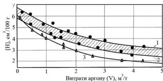
Рисунок 3.16 – Вплив питомих витрат аргону на видалення водню з конструкційної сталі: ● – видалення водню із розкисненої сталі; Δ – видалення водню з нерозкисненої сталі
