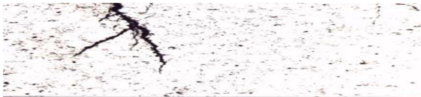
Рис. 5. Міжкристалітна тріщина в сталі 08ХМЧА (×100)
