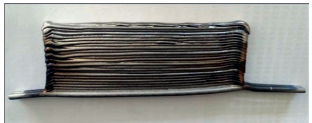
Рис. 8. Пример изделия таврового профиля, полученного методом послойного формирования на дискретной подложке (набор проволок)
