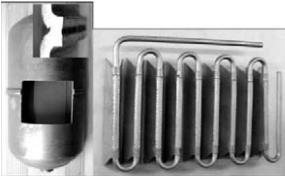
Рис. 5. Лазерная сварка воздушного баллона и испарителя холодильника ЗИЛ из алюминиевого сплава
