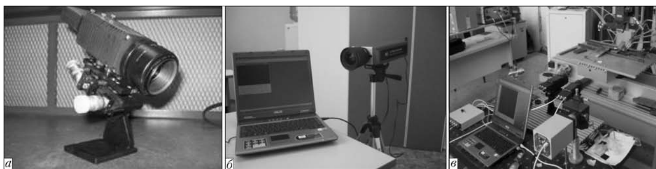
Рис. 1. Оптический блок системы «Регистратор» (а), цифровая высокоскоростная камера CENTURIO C100 (б) и линзовый спектрограф SL100M (в)
