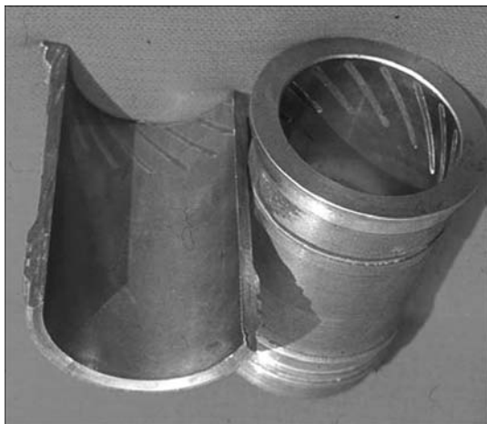
Рис. 1. Гильзы цилиндров с лазерной закалкой зоны компрессии
