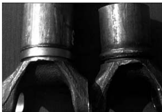
Рис. 2. Карданные валы, сваренные традиционным аргоно-дуговым способом (справа) и лазером (слева)
