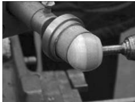
Рис. 2. Пристрій для алмазної доводки керамічної головки
