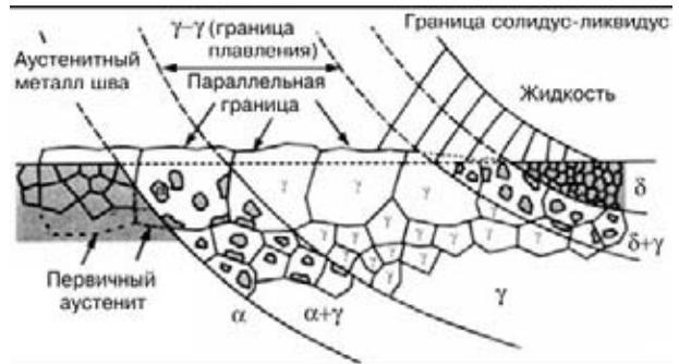
Рис. 4. Кинетика микроструктурных изменений разнородных металлов в сварном шве в зоне, расположенной вблизи границы сплавления (основной металл – углеродистая низколегированная сталь)
