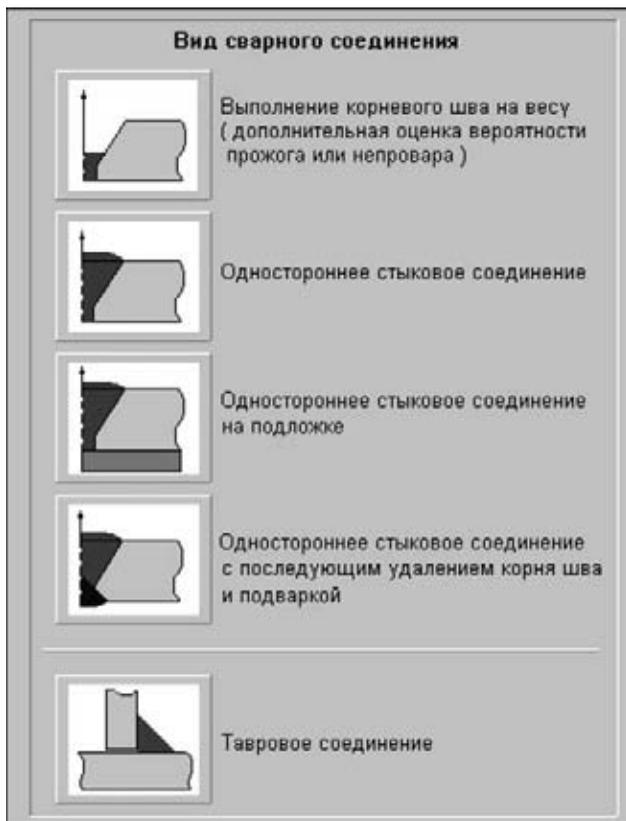
Рис. 3. Виды сварных соединений, предлагаемых пользователю
