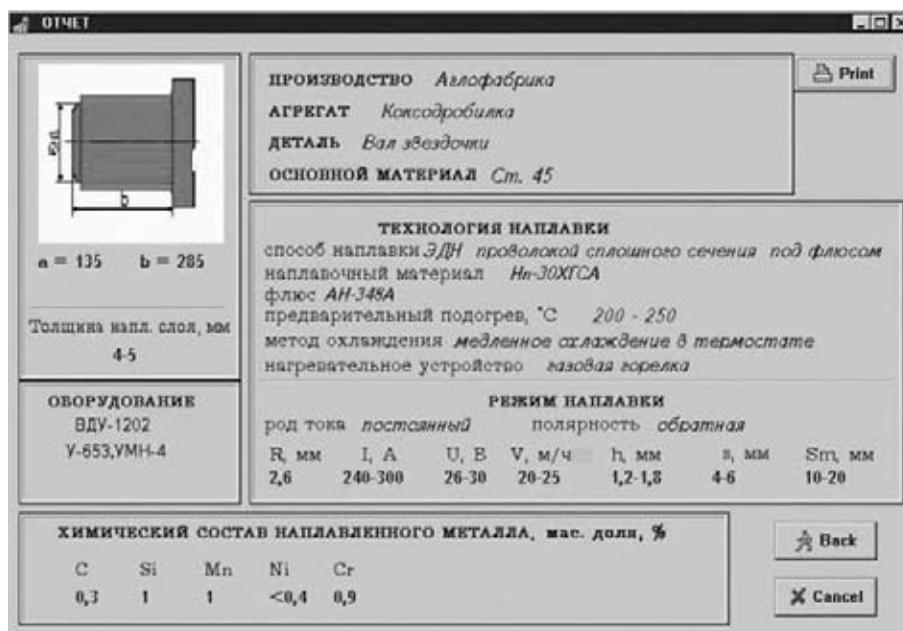
Рис. 3. Итоговый документ работы системы проектирования технологий наплавки деталей металлургического оборудования
