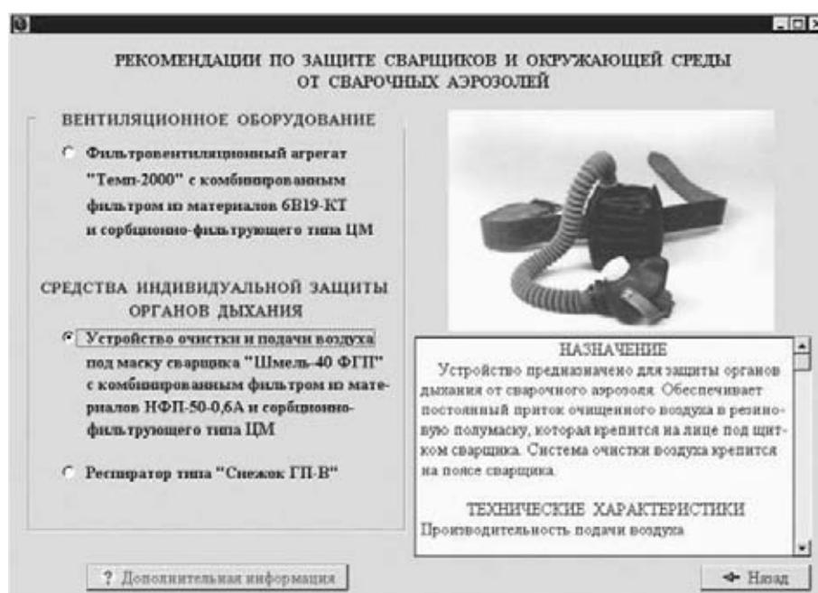
Рис. 5. Рекомендации по защите сварщиков и окружающей среды от сварочных аэрозолей
