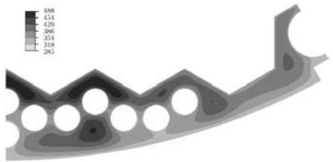
Рис. 7. Распределение температуры в выгородке реактора при работе на максимальной мощности
