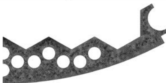
Рис. 4. Конечно-элементная модель выгородки, сектор 30°
