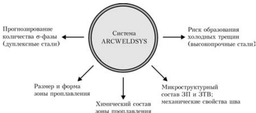
Рис. 2. Задачи, которые можно решить с помощью системы ArcWeldSys
