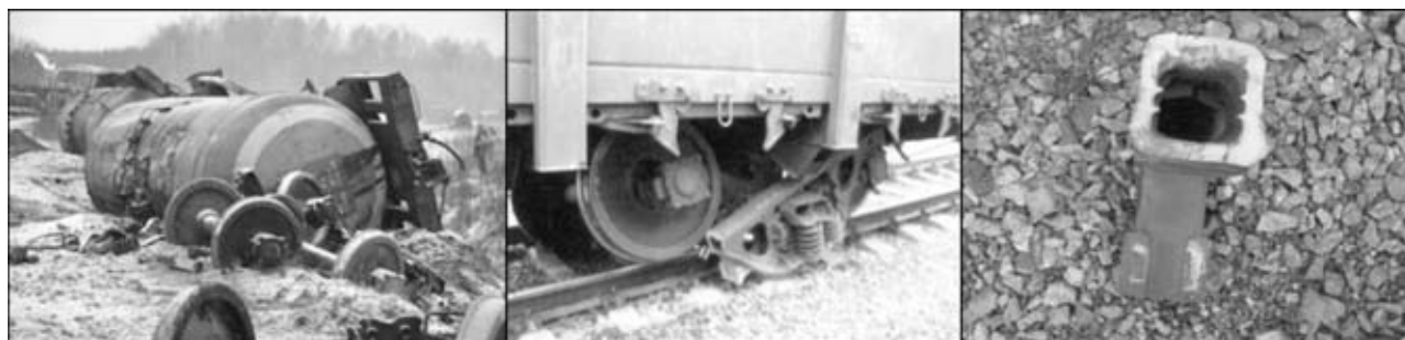
Рис.1 Усталостное разрушение литой конструкция боковой рамы
