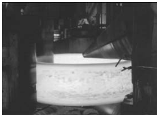
Рис. 3. Горячая раскатка полых заготовок (после прошивки или после ЭШН ЖМ) в обечайки корпусов реакторов на кольцевом станке
