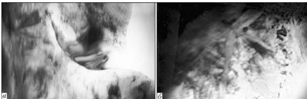
Рис. 2. Тонкая мартенситно-аустенитная (М-А) структура (а, б) обработанных поверхностей стали Р6М5 на режимах № 1(а) и № 2 (б); а, б – ~5 мкм от обработанной поверхности; а – оплавление поверхности (×37000); б – мелкодисперсные структуры (×30000)
