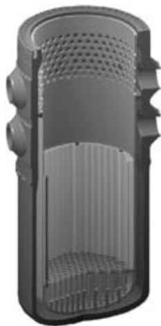
Рис. 1. Конструкция реактора: 1 – корпус реактора; 2 – шахта; 3 – выгородка
